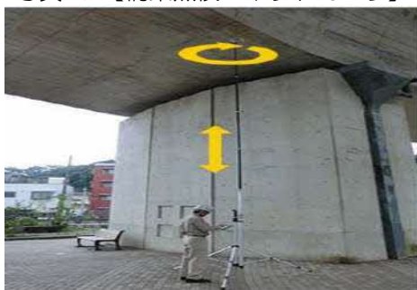
写真-1 【橋梁点検ロボットカメラ】
