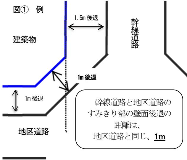
□壁面を持たない開放的な構造（透過部分が70%以上）の手すり状、格子状のベランダ、バルコニー、テラス、デッキ等は壁面後退の対象外とするが、外を道路・隣地各境界線から、 $0.5\text{m}$ 以上離すこと。また、目隠し壁、ルーバー等についても同様とする。
