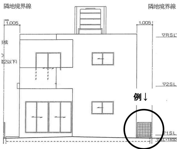
□設備機器、雨どい等をCB塀やRC等、閉鎖的なもので囲わない場合は、壁面後退の対象外とする。
