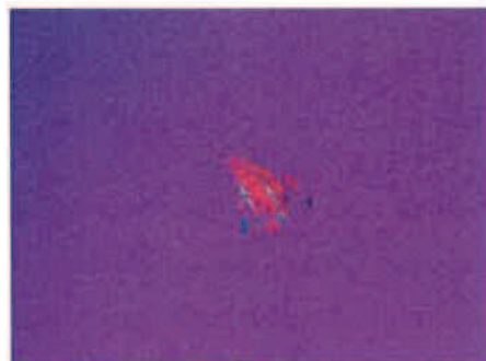
ID No : 6876 結果 : 石綿含有 (クリソタイル) 条件 : 10×10, 1. 550HD, Crs-n, RI
