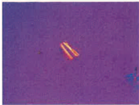
ID No : 6874 結果 : 石綿含有 (クリソタイル) 条件 : 10×10, 1. 550HD, Crs-n, RI
