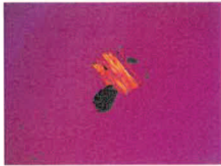
ID. No : 6863 結果 : 石綿含有 (クリソタイル) 条件 : 10×10, 1. 550HD, Crs-n, RI
