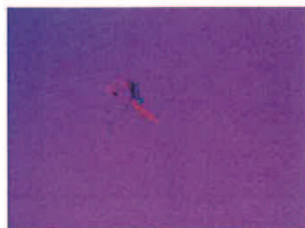
ID No : 6877 結果 : 石綿含有 (クリソタイル) 条件 : 10×10, 1. 550HD, Crs-n, RI
