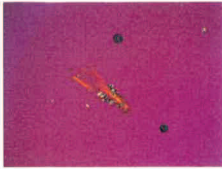
ID. No : 6883 結果 : 石綿含有 (クリソタイル) 条件 : 10×10, 1.550HD, Crs-n, RI
