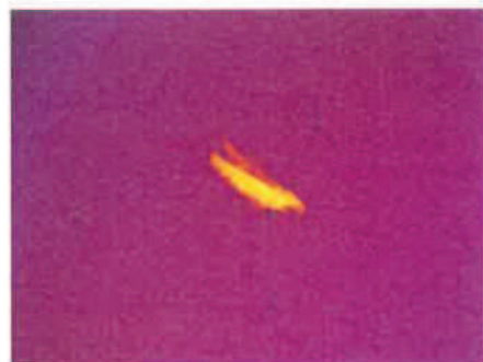
ID. No : 6886 結果 : 石綿含有 (クリソタイル) 条件 : 10×10, 1.550HD, Crs-n, RI
