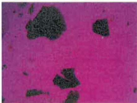
ID.No : 8010 結果 : 石綿含有せず 条件 : 10×10, 1.550HD, Crs-n, RI
