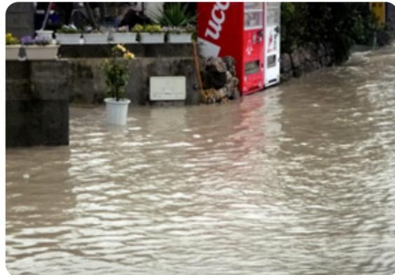
奥間中央線の側溝が集中豪雨のたびに道路冠水がおき、住民生活に支障をきたしている。道路排水が側溝から溢れ、道路面より低い住宅地へ流入する。早急な排水路の改善が必要である。
